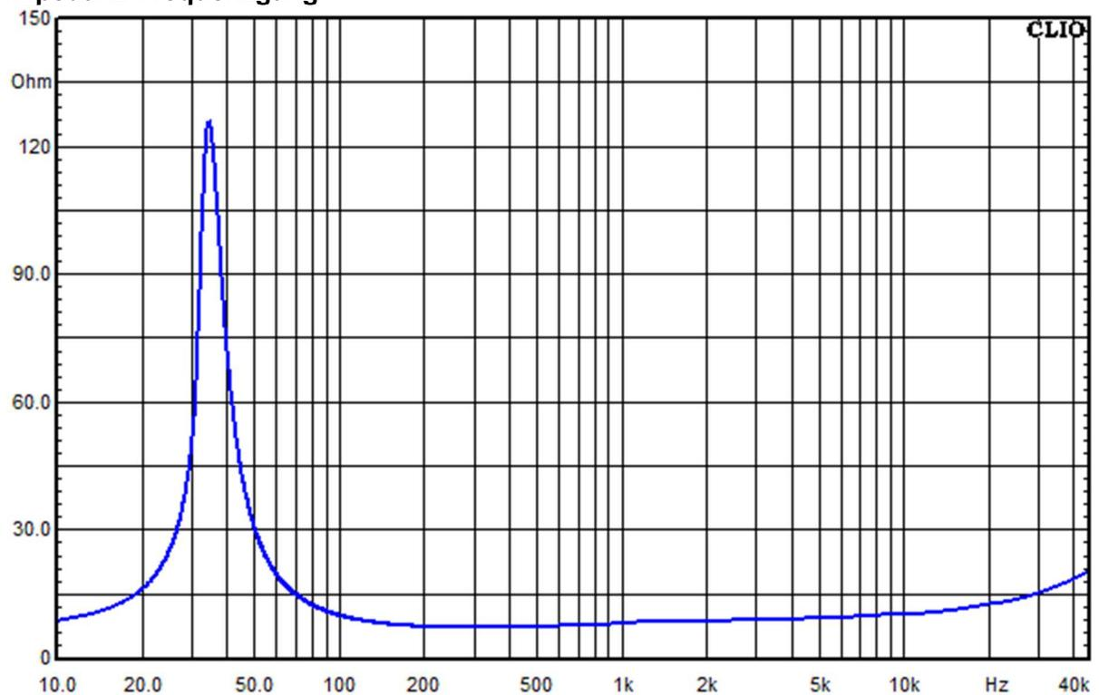
Abbildung 4: Wavecor WF182CU13-Impedanzverlauf
